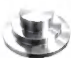
Обточенные штамповки дисков из сплава ВТ8. Заказчик ОАО «КАДВИ»
